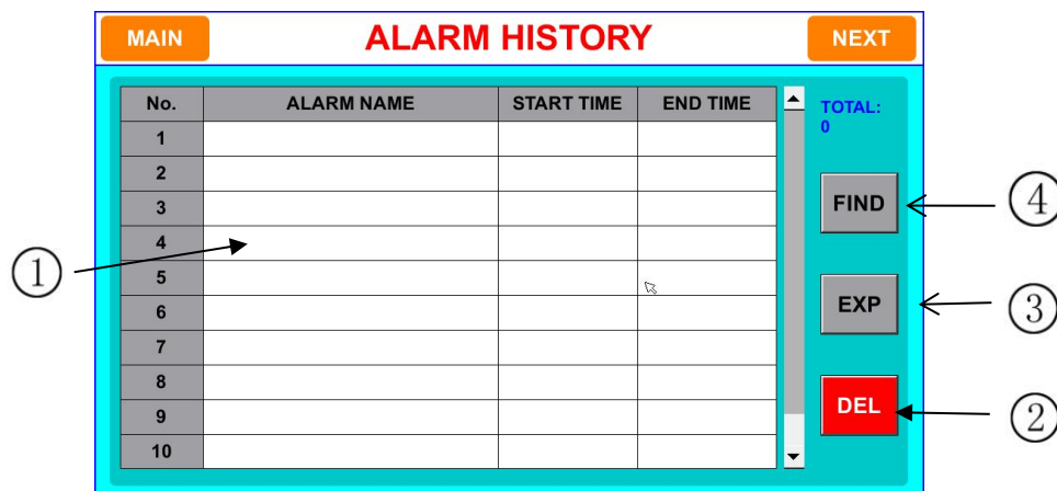
Figure [7-1] DI alarm history
